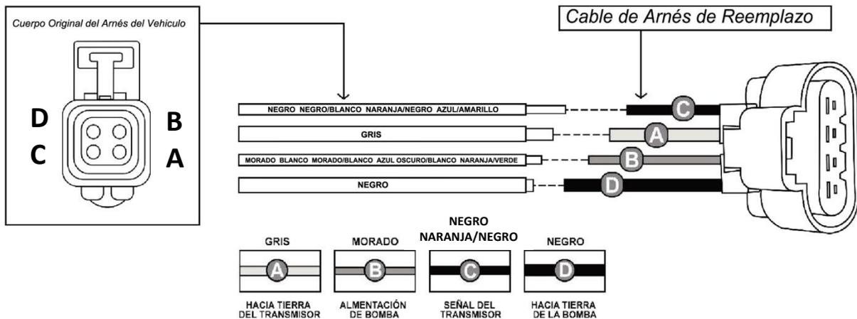
*NOTA: Los conectores engarzados deben estar escalonados para permitir que el arnés entre dentro de la manguilla del cable del vehículo.*
